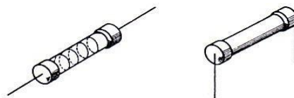
Gambar 1. Hambatan Karbon yang diuapkan Aksial dan Radial
